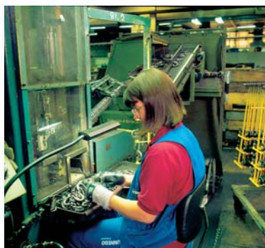
Ieder component is proefbelast en geïnspecteerd
