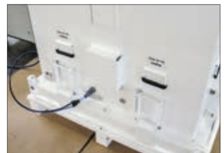
Waterdampdichte laadcontainer bij de beproeving op dichtheid onder overdruk
