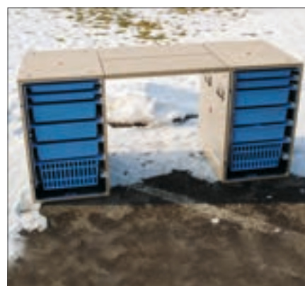
Speciale uitvoering: modulecontainer als werktafel te gebruiken
