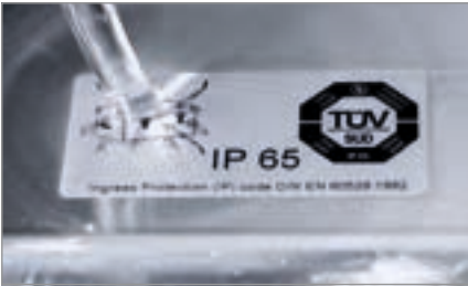
Sproeiwaterdicht conform de norm IP 65
